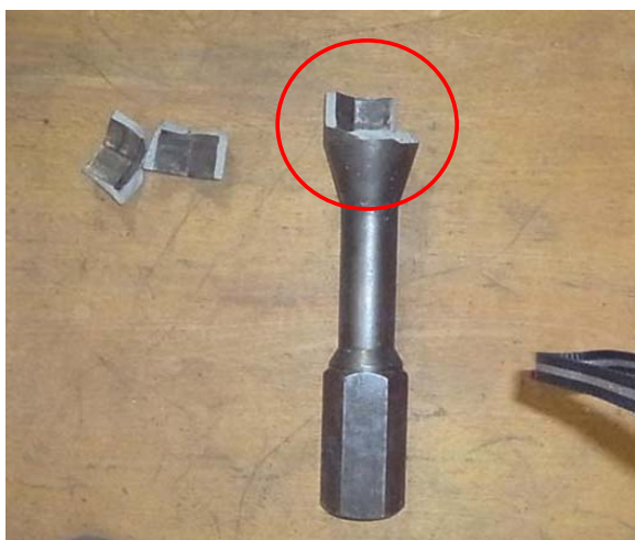
破損部サイズ:46・スパナ取付け部サイズ:54
