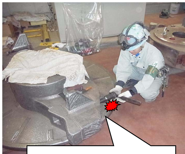
治具にスパナを取り付け、それを手で支えてハンマー打撃していた
